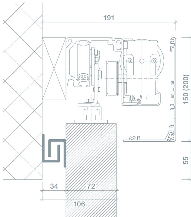
Vertikalschnitt Antrieb und Labyrinthdichtung
