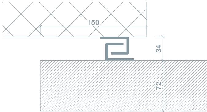
Horizontalschnitt Wand mit Labyrinthdichtung
